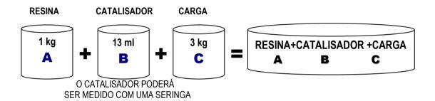
Misturar A + B e depois adicionar o componente C. Misturar bem até encontrar o ponto ideal (massa consistente em condições de trabalho).
